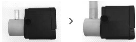
ポンプ取付け口にポンプの排出口を取付けます。チューブは横の空洞部分を通過させ上部から出してサイレンサーと接続します。
